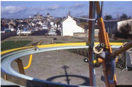
Le tube *oculus* d'une trentaine de cm de long a un diamètre intérieur de 12 mm ; plus loin, dans le prolongement de ce tube et à l'opposé de l'astre, est disposée une cible blanche du même diamètre qui se trouvera « rondement » illuminée lors du parfait alignement. Ce tube *oculus* traverse un plan qui sert de
