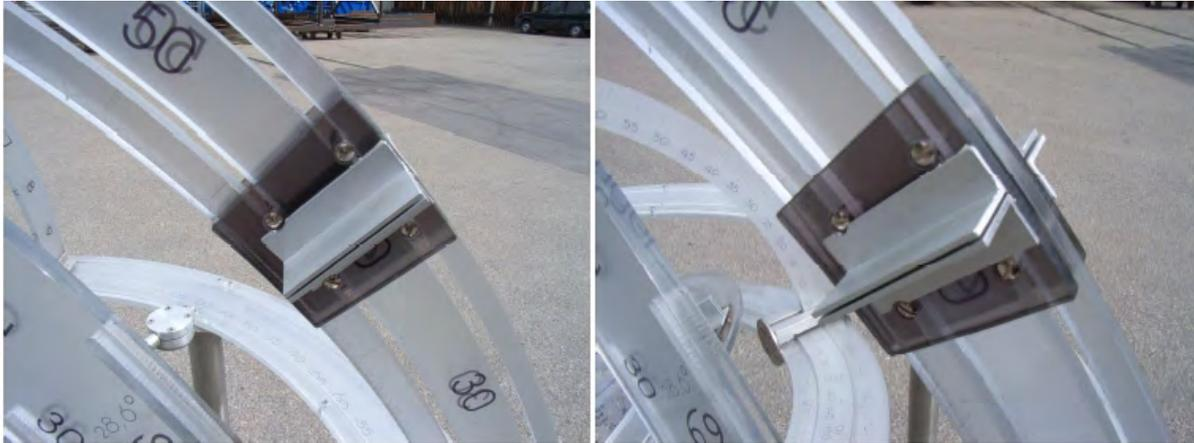
Exactement le même principe que celui de Bisingen a été utilisé à Brittheim. Toutefois dans ce cas, l'instrument n'est pas en acier inoxydable, mais en polycarbonate, un matériau certes esthétique, mais aussi, hélas ! fragile. Pour cette raison, l'instrument n'est exposé au Soleil que dans les grandes occasions. Les deux croix optiques sont en plaques d'aluminium, collées sur des supports en polycarbonate.
