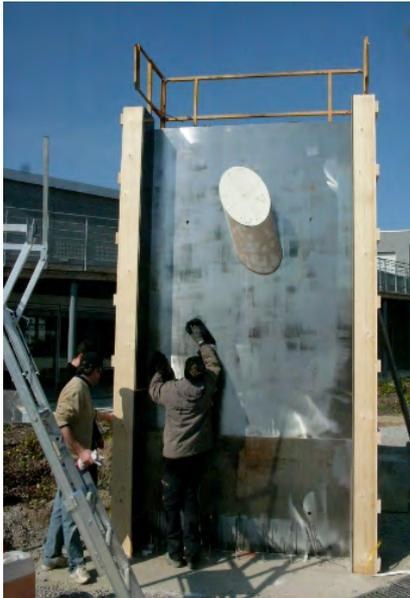
◀ Fig. 2 : coffrage du mur et emplacement du cylindre
