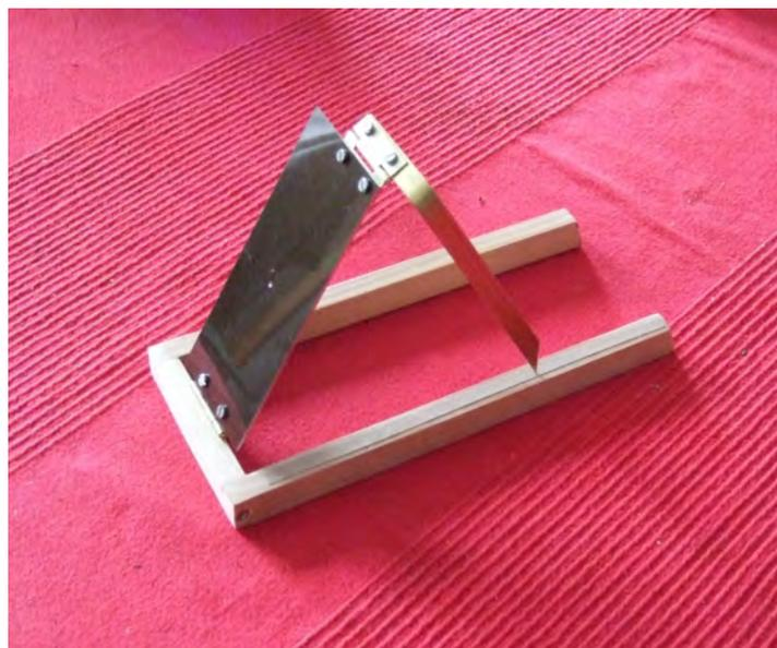
La plaque métallique de 6cm par 13,5cm est percée d'un trou de 1mm. Le soleil donne une petite image nette sur le sol horizontal au milieu de l'ombre de la plaque. La position de la tache dépend de l'inclinaison de la plaque et a son extremum lorsque la plaque est perpendiculaire aux rayons du soleil.
