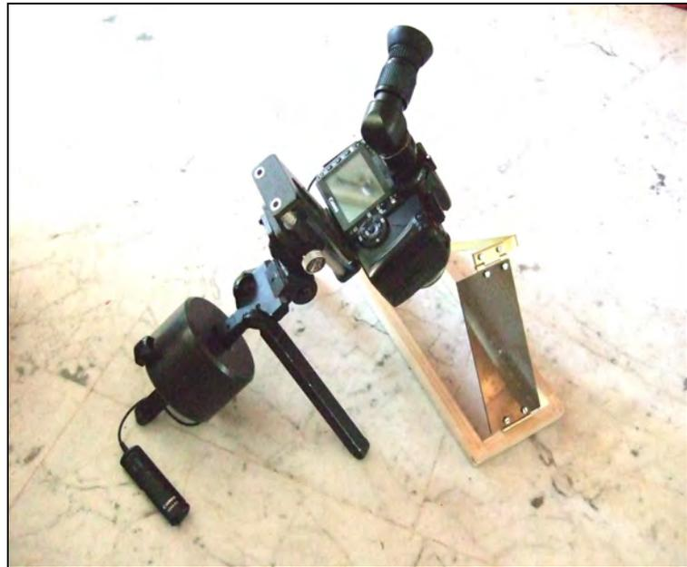
On peut alors ajuster son inclinaison de façon à rendre la plaque perpendiculaire aux rayons du soleil. Un déplacement doux de l'appareil le long de la table de mesure provoque le déplacement de l'image de la barre horizontale. L'image du soleil, rendue oblongue par l'inclinaison des rayons par rapport à la table de lecture est traversée par l'image de la barre horizontale. En faisant glisser le *yingfu*, l'œil de
