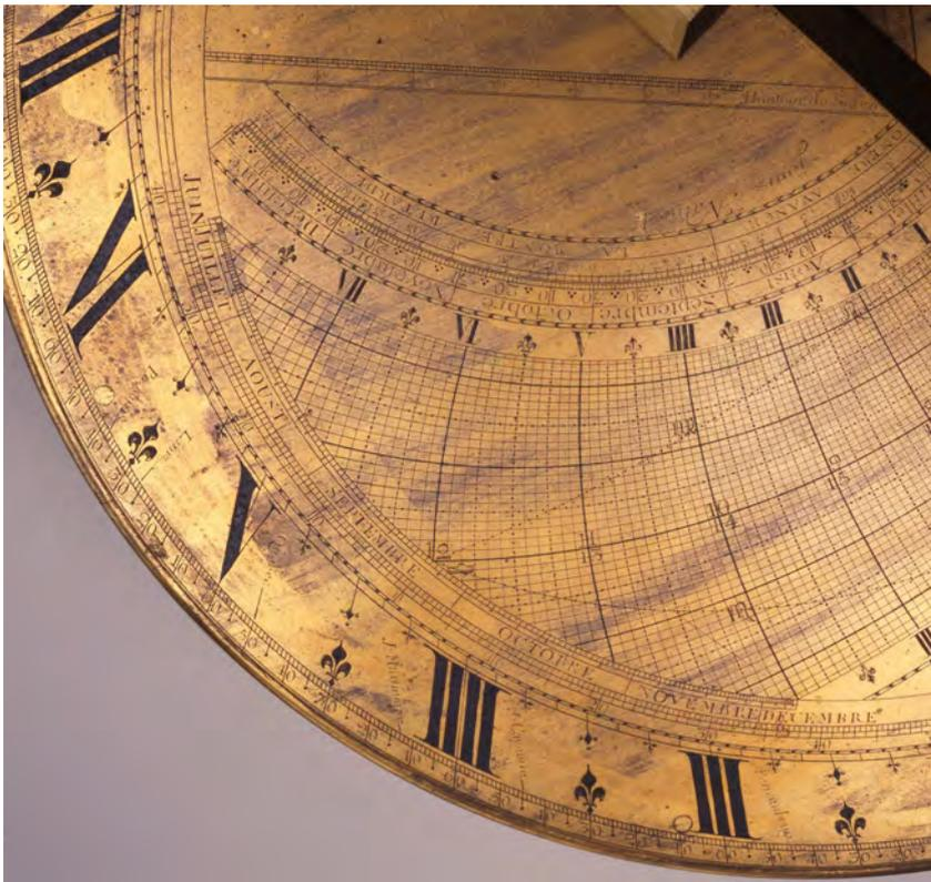
**Figure 10** – Détails sur les informations astronomiques figurant dans la partie correspondant aux heures de l'après-midi. Les deux cercles de l'écliptique se rencontrent sur l'équateur qui est aussi l'intersection avec le cercle horaire VI, le 23 septembre. En dessous le cercle des amplitudes indique 0.
