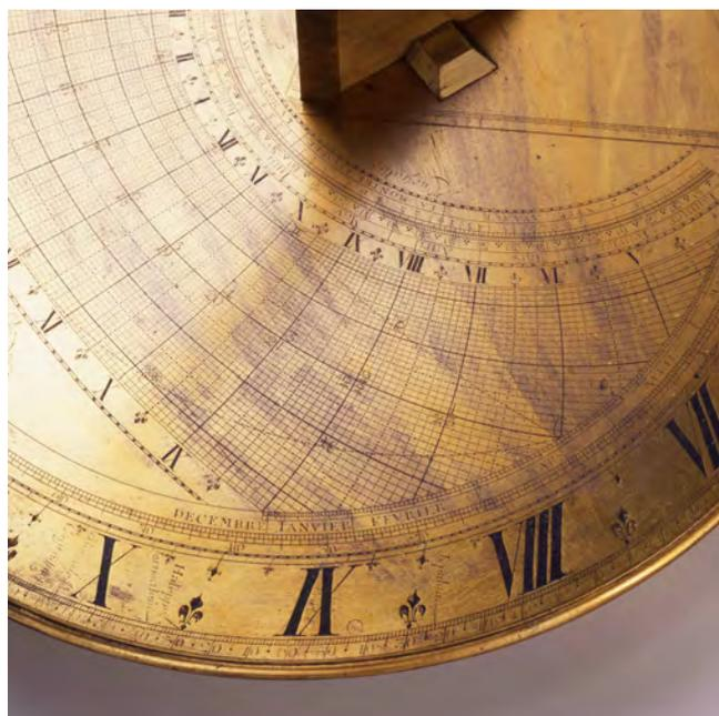
**Figure 3** – Photographie rapprochée de la partie correspondant aux heures du matin. On voit nettement au-dessus de la couronne en chiffres romains le canevas stéréographique avec les deux arcs de cercle de l'écliptique.
