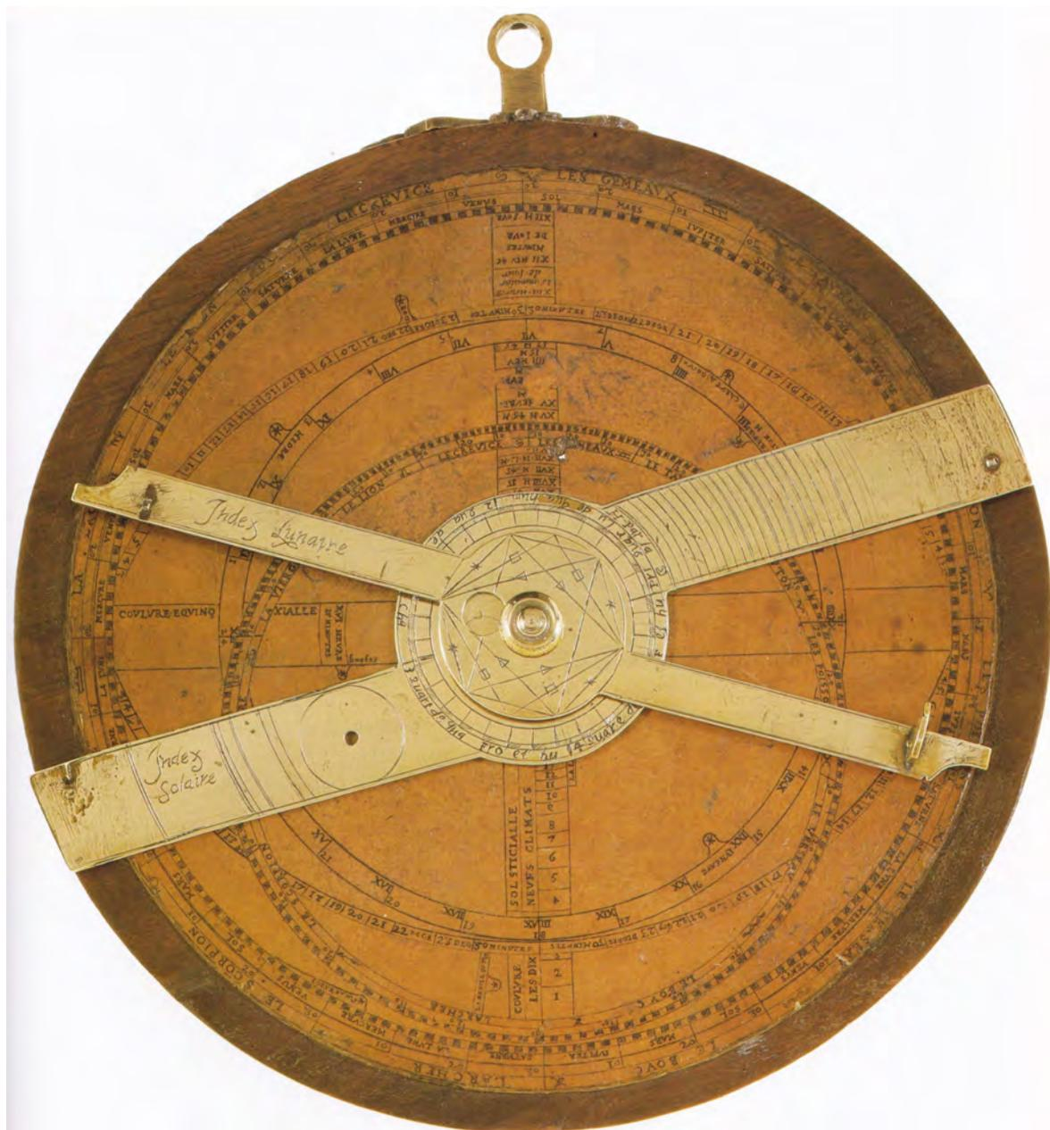
**Figure 5** – Le Pantocosme, partiellement réalisé, de l'ancienne collection du Time Museum. Les index, simplifiés, sont en laiton mais l'araignée n'est pas évidée. On note la présence de pinnules sur l'index lunaire.
