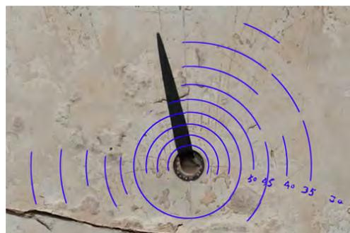
**Figure 8** – Cercles de la hauteur du Soleil observés sur la table. Sur cette image, l'ombre du gnomon indique que le Soleil est situé à 33° au-dessus de l'horizon.
