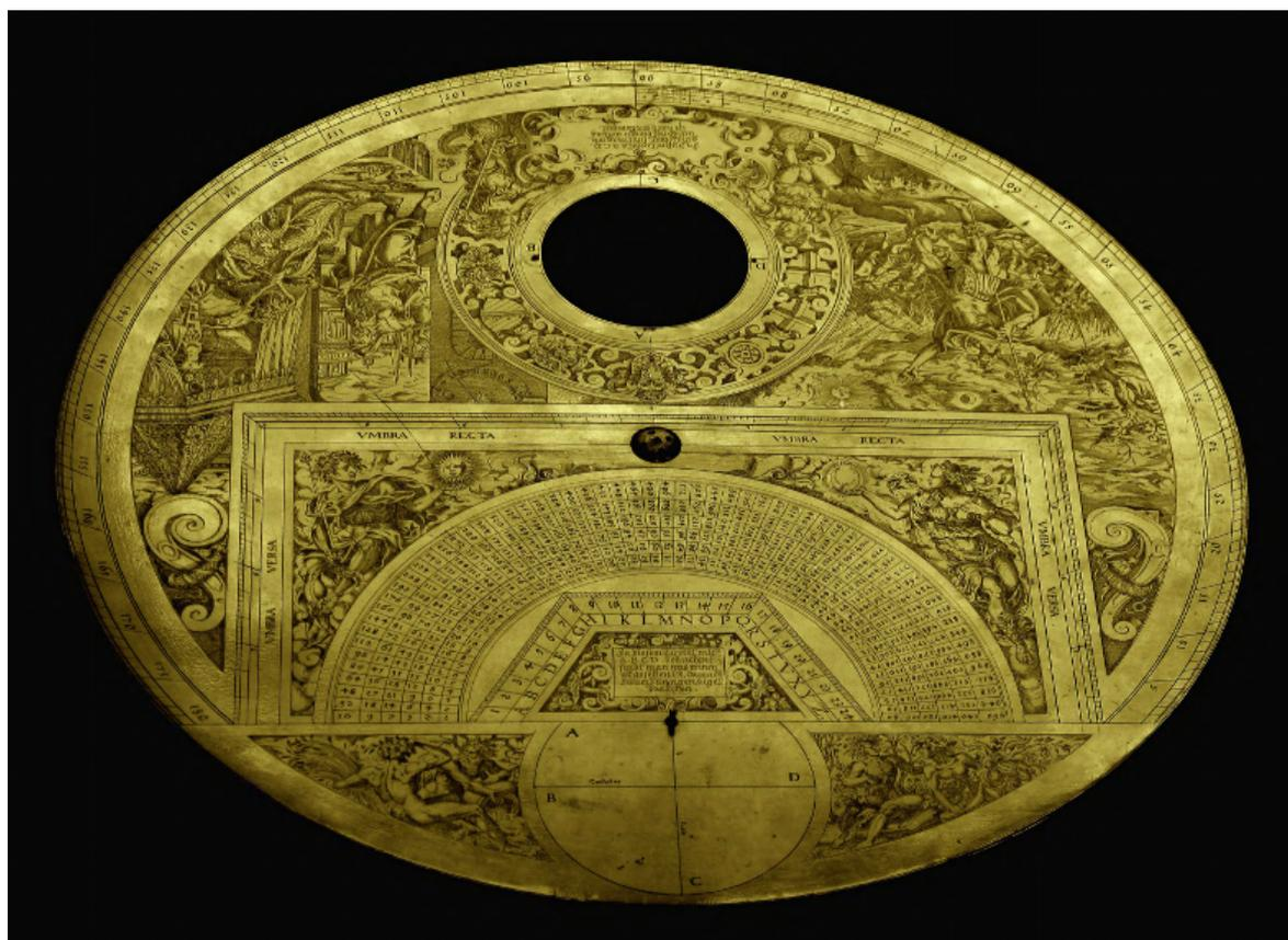
**Figure 2** – Face B de mesures et du carré des ombres du disque de Wenzel Jamnitzer de l’Observatoire de Paris.
