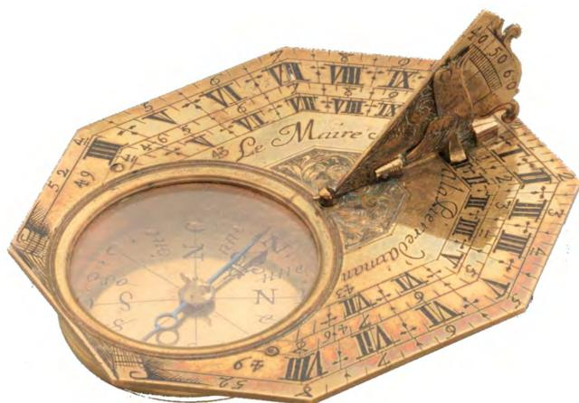
**Figure 1** – Un cadran de type « Butterfield » (instrument signé Le Maire).
