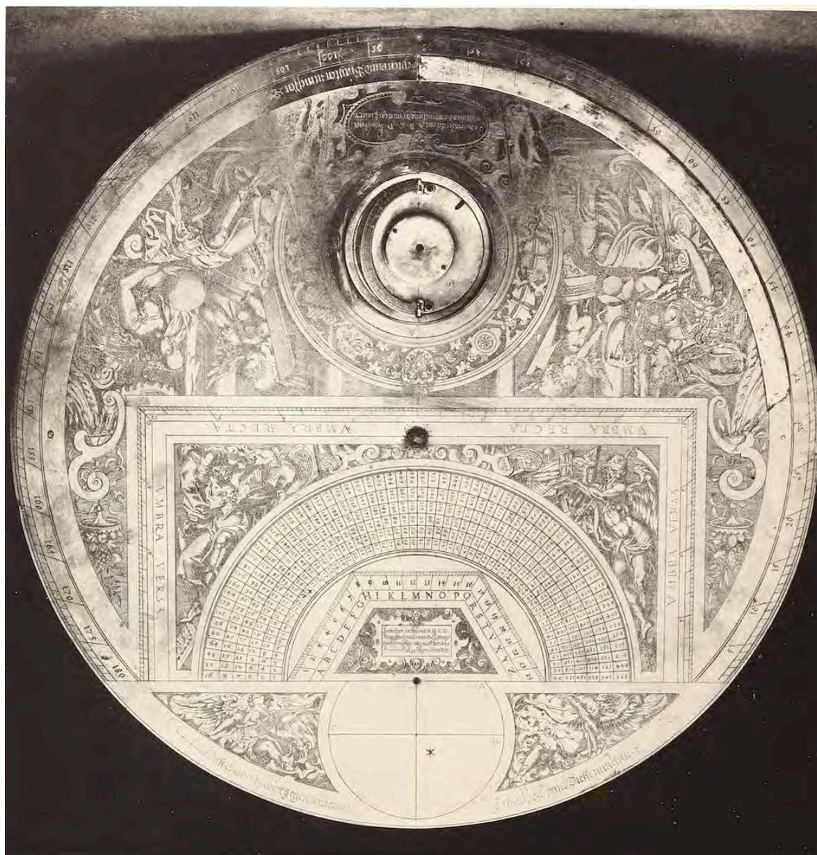
Figure 4 – Face de mesures et du carré des ombres du disque de Dresde.
