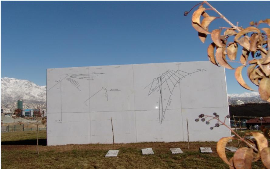
Fig. 13 : Les cadrans de la face Sud en hiver au matin : le Soleil vient de franchir le plan du cadran, les ombres des styles sont très longues.
