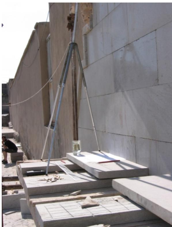
Fig. 3 Détermination de l'orientation du mur par la méthode de la planchette.
