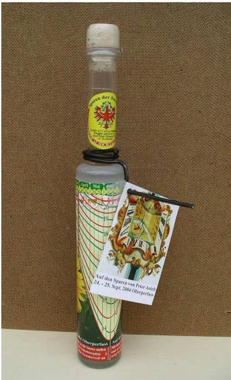
Il s'agit d'une classique horloge solaire de hauteur ou de "Berger", tracée une bouteille en verre de 32 cm dont la partie cylindrique est de 20 cm de hauteur et de 4,5 cm de diamètre. Sur le col de la bouteille a été placé un gnomon horizontal, en fil de fer rigide de 6 cm de longueur qui peut tourner grace à sa partie en spirale, autour du col de la bouteille.
