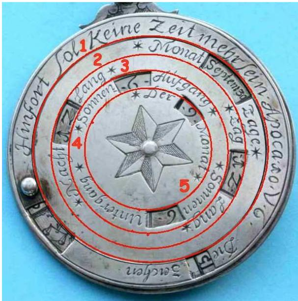
Un disque inférieur est découvert par un disque supérieur percé de guichets disposés en couronnes numérotées.
