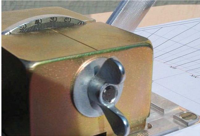
L'heure lue sur le cadran étant la même que celle de la montre au jour de la mesure, il suffit donc de plaquer le grand rapporteur d'angle sur une partie du mur représentative de la géométrie de la surface où sera installé le cadran, puis, de faire pivoter la table seule du cadran. La mesure de la déclinaison du mur sera lue lorsque l'heure de la montre et celle du cadran seront identiques.
