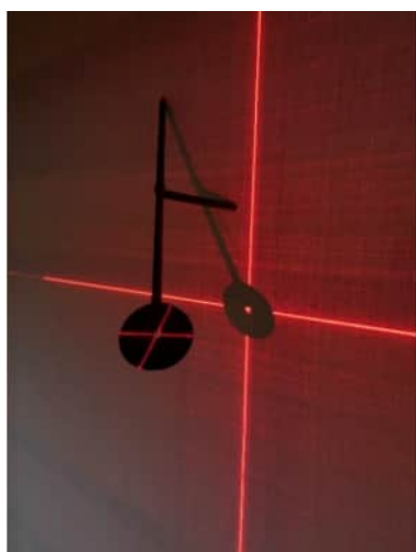
FIG. 11 – Repérage de la position en X de la projection orthogonale de l'œilleton à l'aide de la nappe horizontale d'un laser. Important : la nappe verticale ne dessine pas la ligne de plus grande pente sauf si la surface est verticale et même dans ce cas, sauf précaution particulière, elle ne passe pas par la projection orthogonale ( Y = Y_S ) de l'œilleton. Crédit photo : G. Vincent, 2020.
