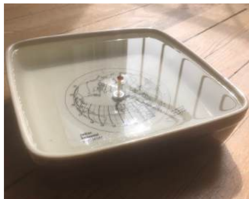
Fig. 5 - Un récipient contenant 4,5 cm de hauteur d'eau. Le tracé a été collé au fond, et un style vertical perce la surface de l'eau.
