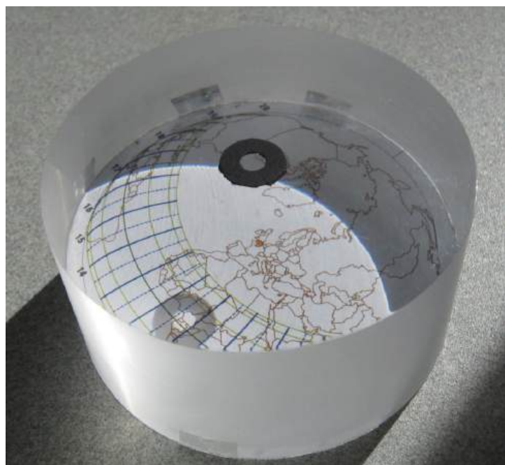
Fig. 7 - Cadran à réfraction (cylindre de Plexiglas de 5 cm d'épaisseur et 10 cm de diamètre).
