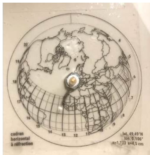
Fig. 6 - Dispositif vu de dessus. Là où le style vertical perce la surface de l'eau, la déformation de la surface produit une tache lumineuse au fond, qui indique l'heure solaire et la position du point subsolaire (ici au large de l'Afrique de l'Ouest).
