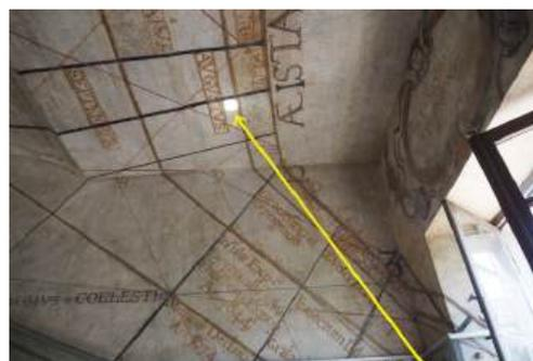
*Ci-dessus la tache lumineuse reflétée par le miroir de la fenêtre côté est vient de passer la ligne de 1 h et indique 1 h 10 environ. Les heures 2 et 3 sont marquées au bout des épaisses lignes noires suivantes.*
