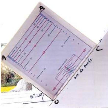
Les côtés AB et OC sont parallèles à l'axe du monde, les côtés OA et BC leur sont perpendiculaires, inclinés d'un angle sur l'horizon de  $90^\circ - \text{LAT}$  (LAT est la latitude du lieu). Les 2 faces du plan OABC constituent le cadran oriental et le cadran occidental. Les bords larges inférieurs OC portent de chaque côté des « cadrans de l'abbé Guyoux », en position midi.
