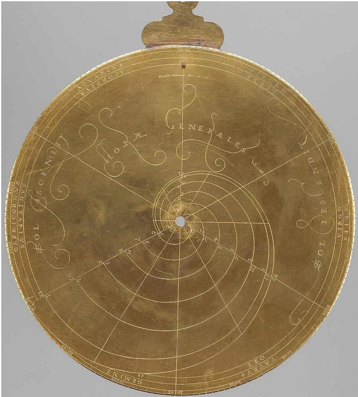
FIG. 9 – Cadran solaire vertical de hauteur d’Habermel en cuivre plaqué d’or (155 mm de diamètre) avec courbes horaires spiralées et gnomon central du Kunsthistorisches Museum daté 1589 (Photo©Kunsthistorisches Museum).
