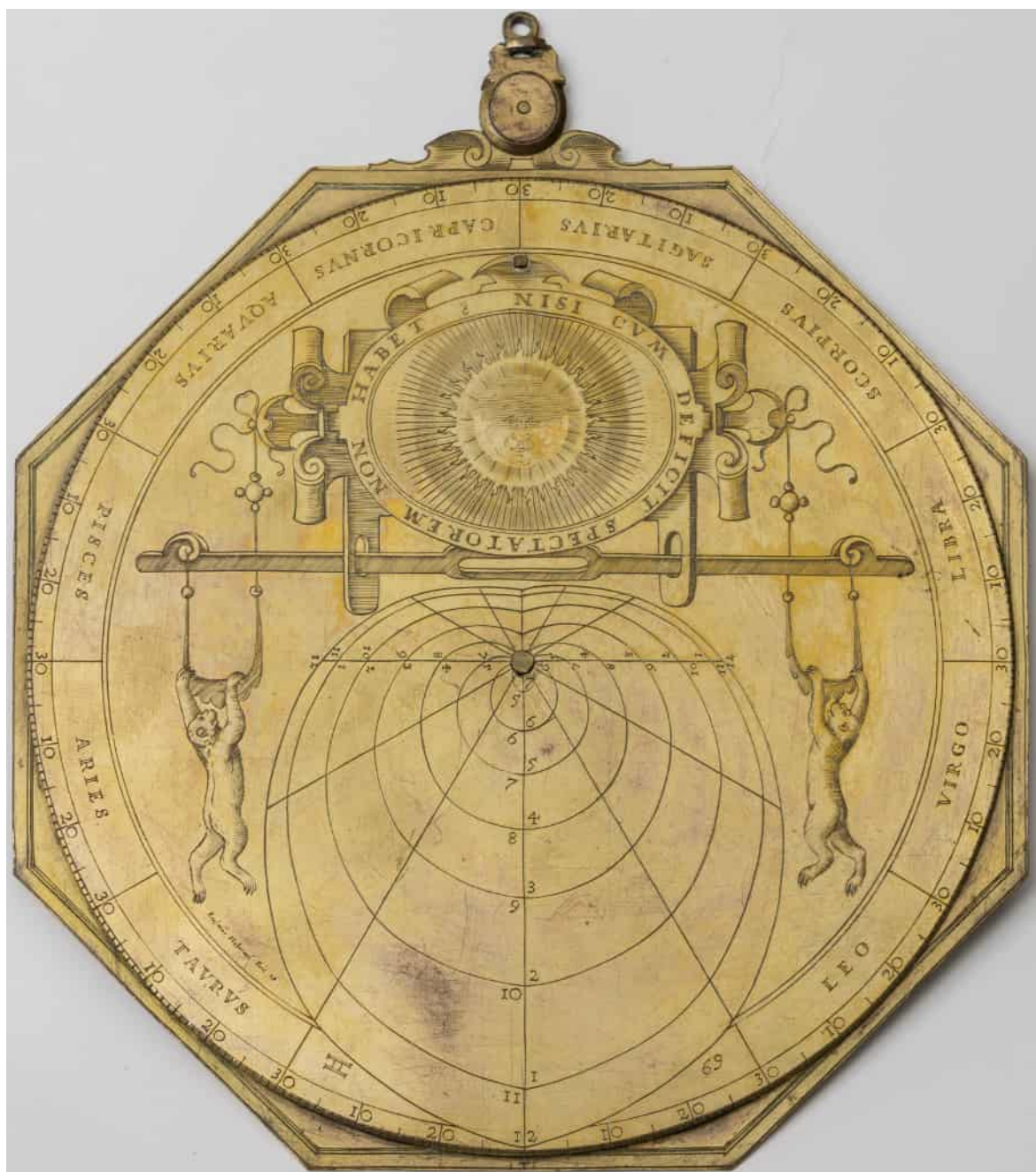
FIG. 12 – Cadran solaire vertical de hauteur d’Habermel en laiton (diamètre 160 mm) avec courbes horaires en limaçon de Pascal de l’Historisches Museum (Photo©Historisches Museum).
