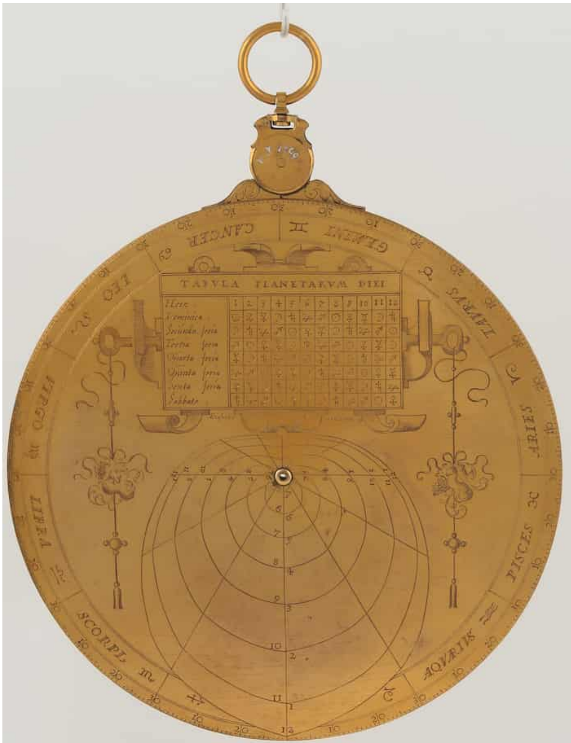
FIG. 15 – Cadran solaire vertical de hauteur d’Habermel en laiton (diamètre 158 mm) avec courbes horaires en limaçon de Pascal et table des régents planétaires du Germanisches National Museum daté 1586 (Photo©Germanisches National Museum).
