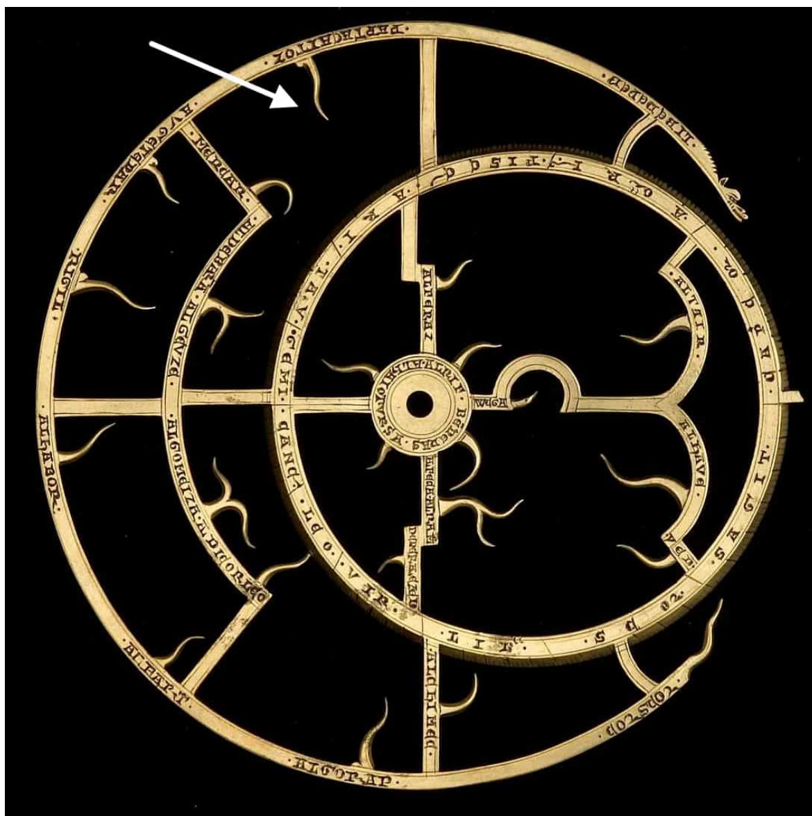
FIG. 7 – L’araignée de l’astrolabe 41468 du History of Science Museum d’Oxford qui est comparé à celui de la miniature par Michel (1960). L’image est présentée ici dans une position qui facilite la comparaison avec l’araignée de la miniature. La flèche localise \xi Ceti, nommée ici : « Partacaitoz », nom qui ne semble jamais avoir été utilisé par Fusoris et qui est dérivé du nom arabe de l’étoile « Bata Kaïtos ».
