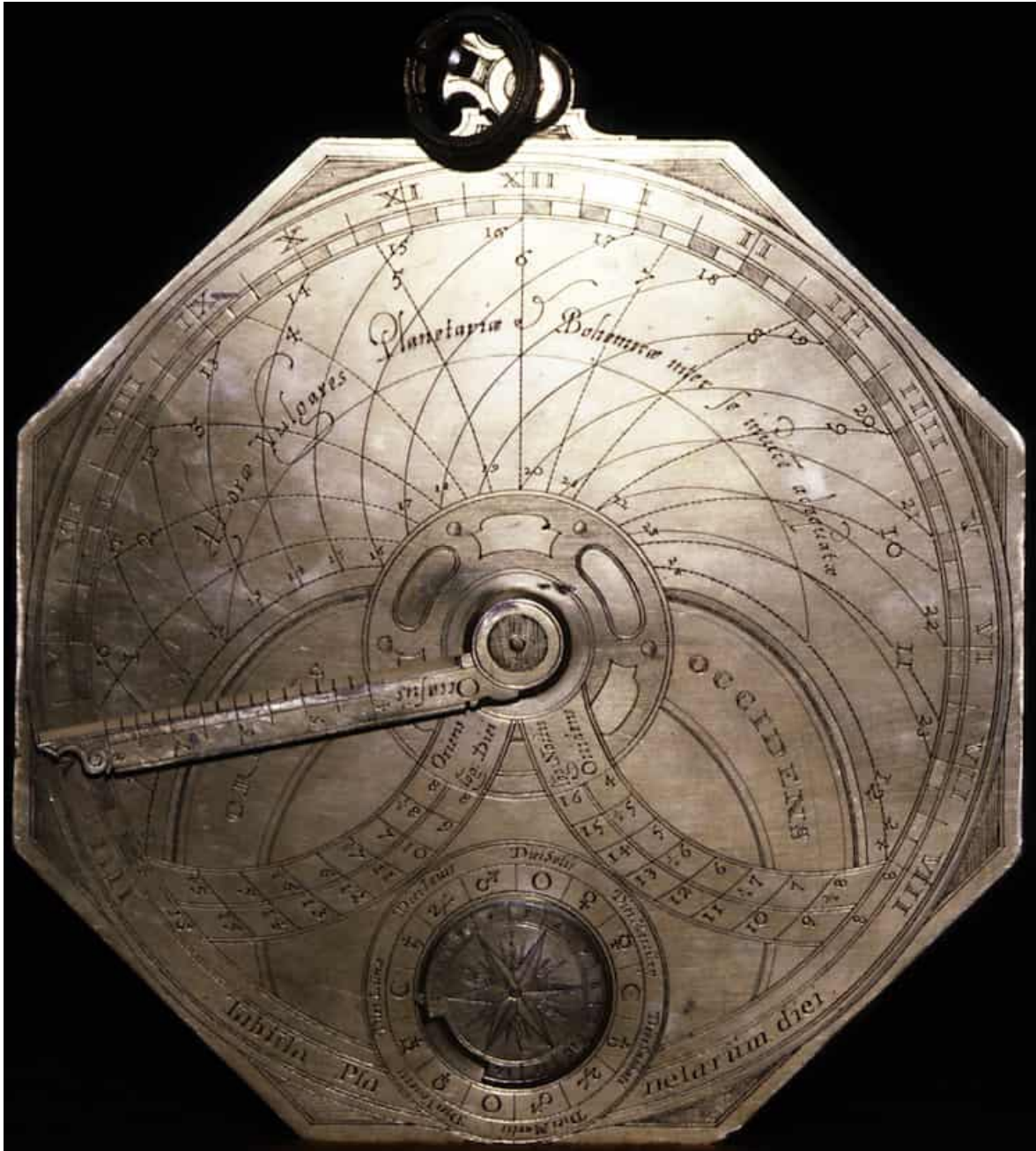
FIG. 6 – Dos du cadran vertical de hauteur d’Habermel du Deutsches Museum qui comporte un convertisseur de l’heure solaire en heure planétaire et bohémienne (Photo©Deutsches Museum).
