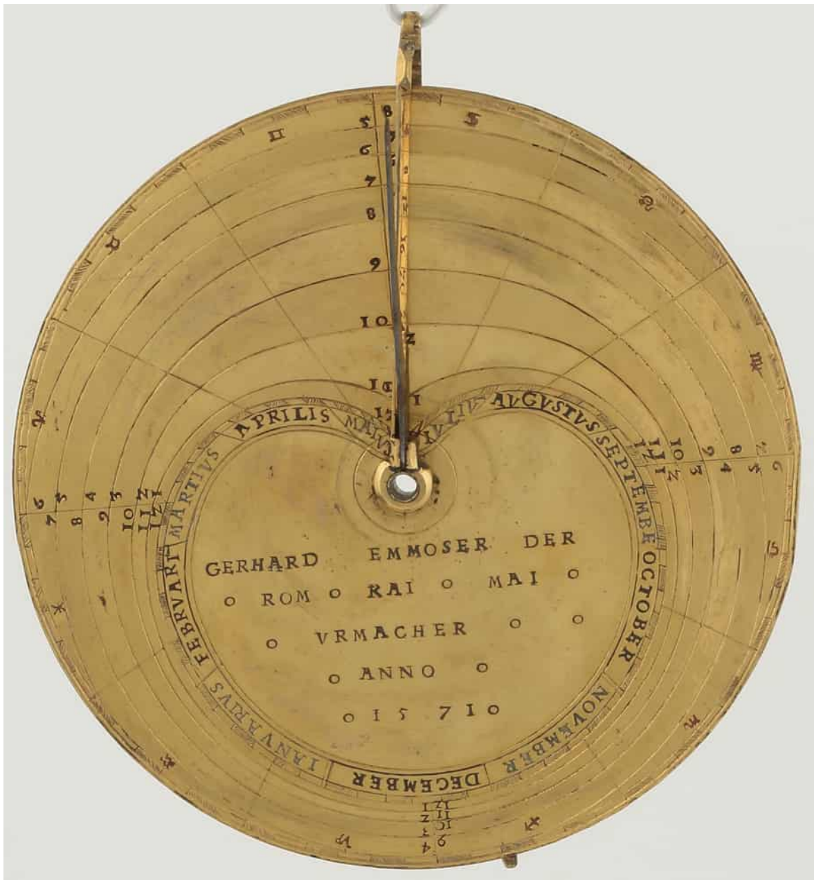
FIG. 16 – Cadran solaire vertical de hauteur en laiton (diamètre 120 mm) de Gerhard Emmoser avec courbes horaires en limaçon de Pascal du Germanisches National Museum daté 1571 (Photo©Germanisches National Museum).
