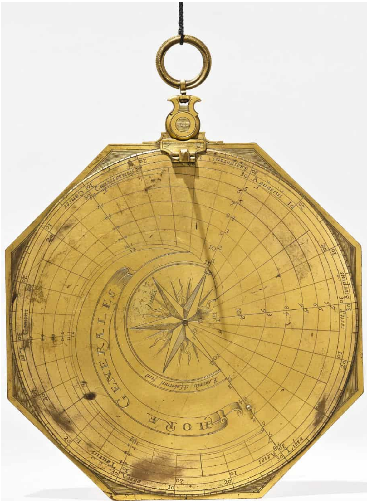
FIG. 1 – Cadran solaire vertical de hauteur d’Habermel en laiton (diamètre 209 mm) avec courbes horaires spiralées et gnomon périphérique du Deutsches Museum (Photo©Deutsches Museum).
