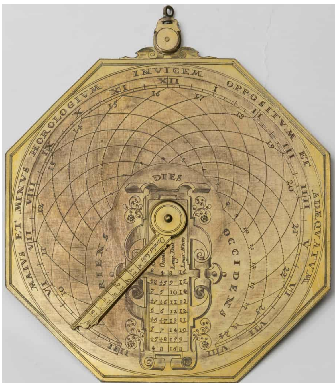
FIG. 14 – Dos du cadran d’Habermel de l’Historisches Museum qui comporte un convertisseur de l’heure solaire en heure babylonique et bohémienne (Photo©Historisches Museum).
