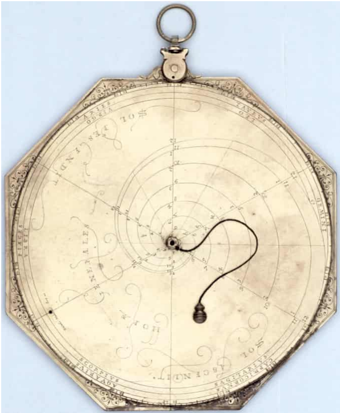
FIG. 10 – Cadran solaire vertical de hauteur d’Habermel en cuivre doré (diamètre 160 mm) avec courbes horaires spiralées et gnomon central du Science Museum d’Oxford daté 1586 (Photo© History of Science Museum , University of Oxford).
