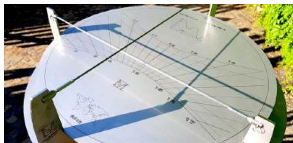
Cadran bifilaire à table circulaire horizontale
