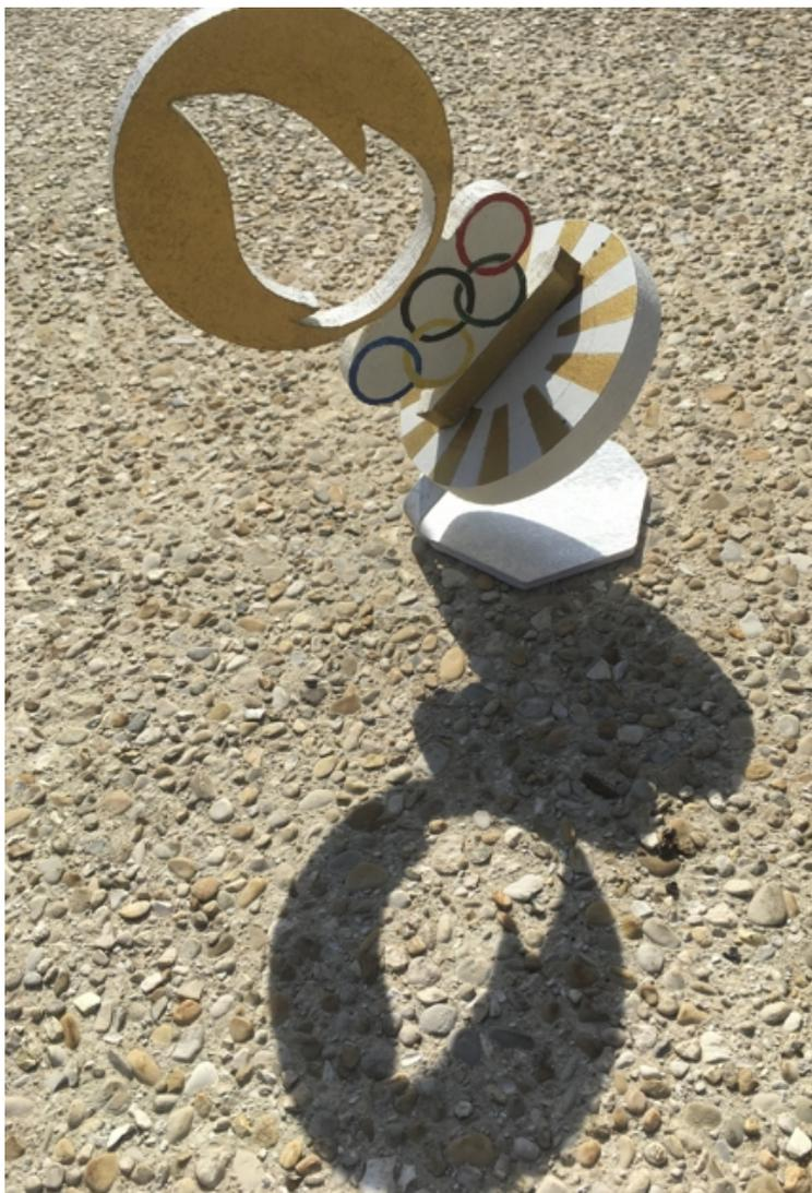
Il s'agit d'un cadran de type équatorial. L'heure solaire (TV) est indiquée par le plan contenant la flamme et son pied solidaire. Il est à faire pivoter en direction du Soleil.
