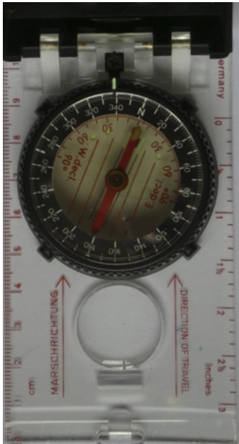
Boussole traditionnelle permettant la mesure de l'orientation d'un mur et le relevé d'orientation sur carte
