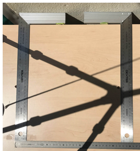
Exemple de photo pour un relevé d'ombre
