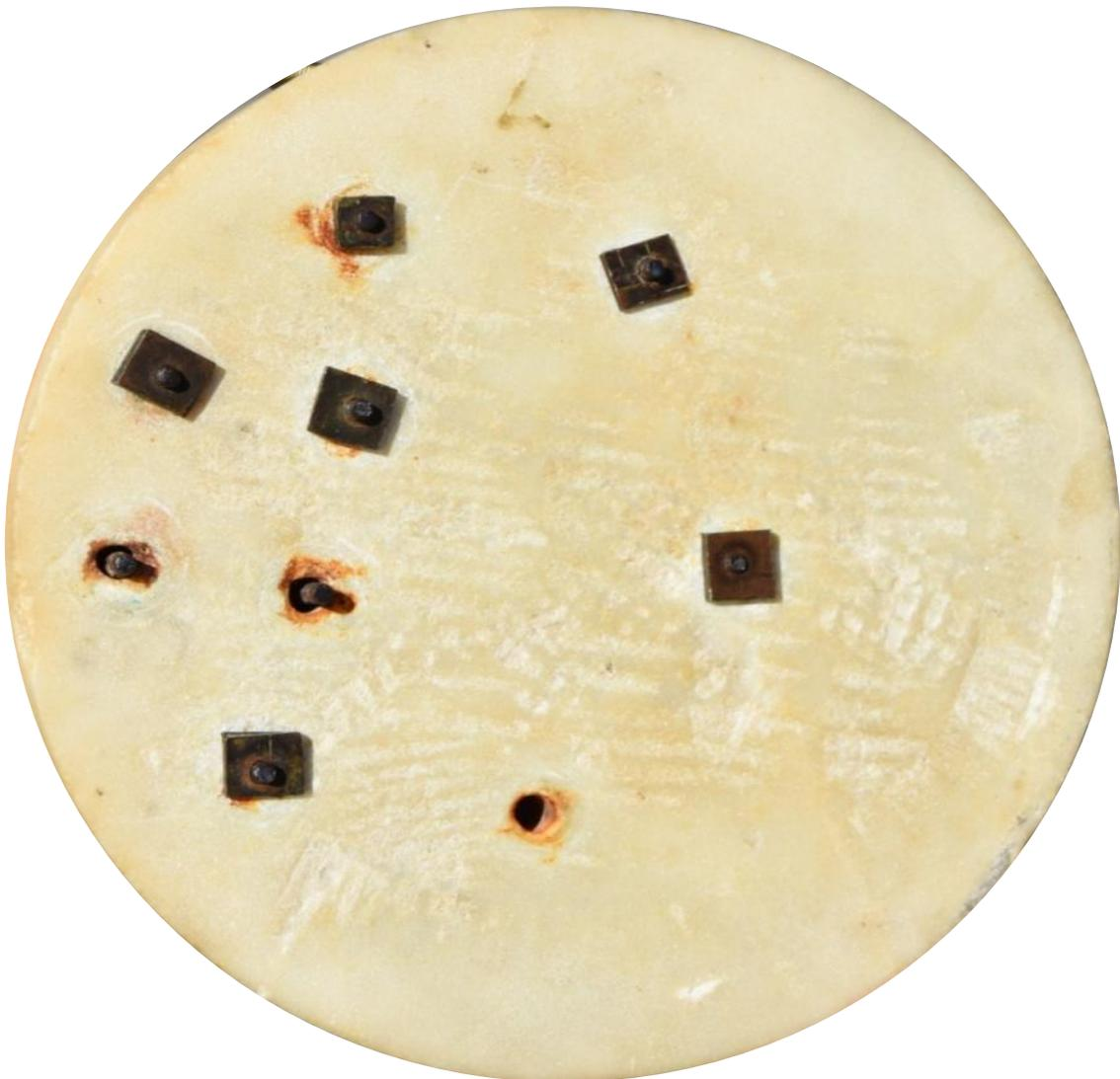
Diámetro de la base de mármol: un palmo. Orificios, tornillos y tuercas de sujeción de las piezas metálicas en la cara inferior de la placa circular de mármol: cureña (2+2), soportes de la lente (2+2) y gnomon (1). Ha perdido tres tuercas y un tornillo.
