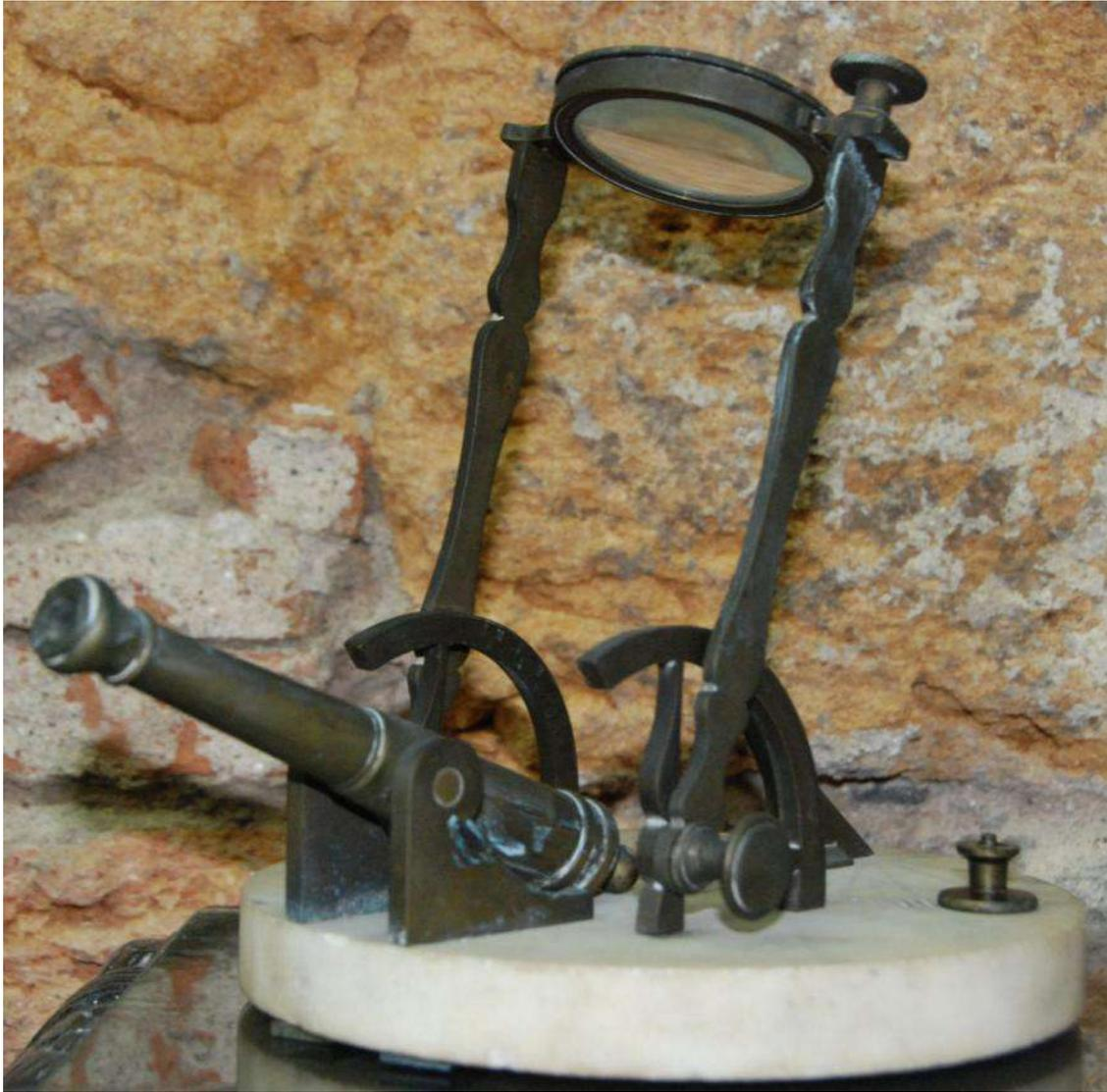
Fotografiado después de colocar las gualderas y el cañón en posición correcta. Falta soldar el tornillo derecho de sujeción de la lente e intercambiar los soportes para que la escala de altura del sol se vea desde el exterior.
