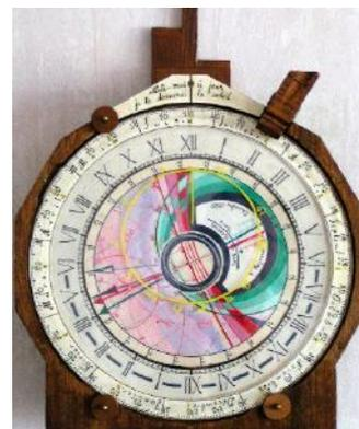
On aura compris que l'appareil est basé sur le principe de la projection stéréographique si importante pour le tracé des astrolabes (d'où son appellation un peu prétentieuse), mais cet objet est avant tout une œuvre de cœur.
