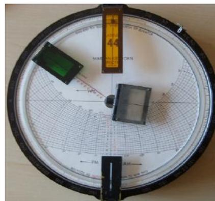
résolution de problèmes astronomiques communs à tout astrolabe en plus d'un avantage considérable qu'est l'auto-orientation sur le nord vrai. L'élément fondamental recherché est l'azimut (ou cap en terme de navigation), et les éléments qui le déterminent sont la hauteur du soleil, la déclinaison du soleil (date) et la latitude (choix du tympan).
