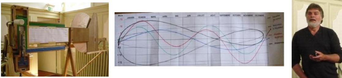
Président du club d'astronomie Orion de Saint-Maurice-l'Exil, M. Gulon a réalisé une étonnante machine pour simuler le tracé de l'équation du temps. A l'aide de roues, d'engrenages et de cames, le mécanisme permet de tracer la courbe de l'équation du temps sur une feuille de papier. La présentation et le fonctionnement de cette machine (2 m de longueur sur près de 1,5 m de hauteur) ont impressionné tous les participants.
