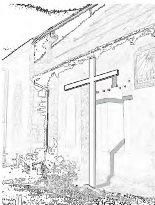
**FIGURE 11** – Schéma de principe du porte-ombre du cadran de la fresque. Dans des conditions favorables, celui-ci projette, sur le mur, une ombre verticale qui se déplace de l’Ouest vers l’Est en atteignant successivement les chiffres 10, 11, 12, 1, etc.
